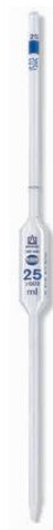
种植类土壤中水解性总酸度的测定项目中所使用的胖肚移液管
