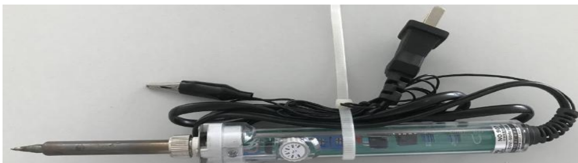
可调温烙铁（尖头、功率 60W） 如下图所示
