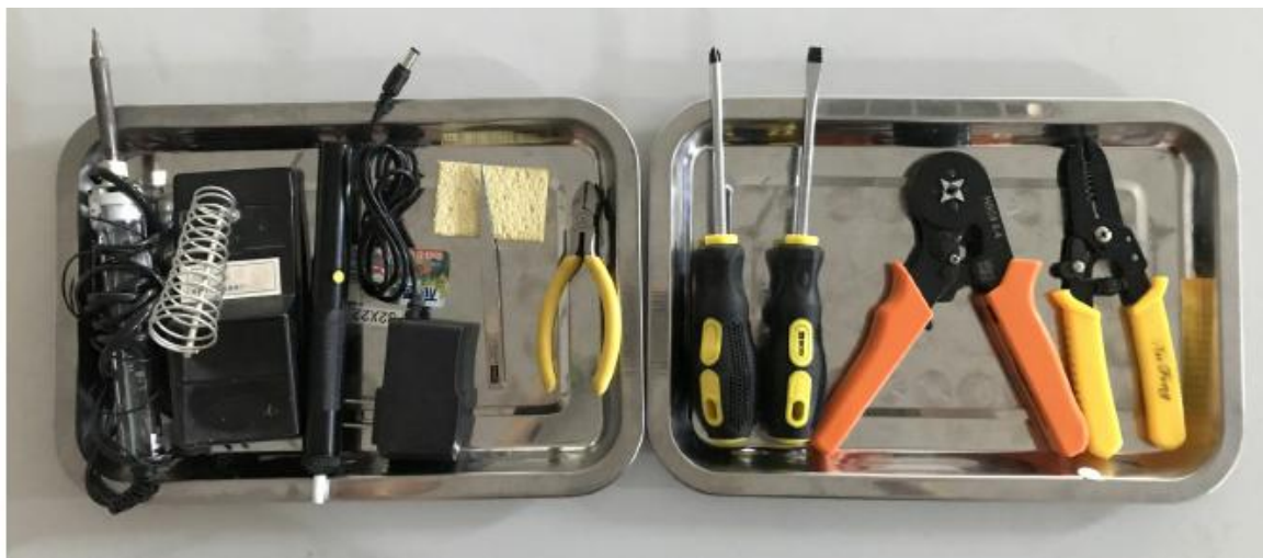
可调温烙铁（尖头、功率 60W） 如下图所示
